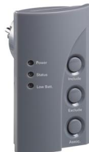
**Abbildung 6.8: Düwi – Funkzentrale zur Administration größerer Netze**
