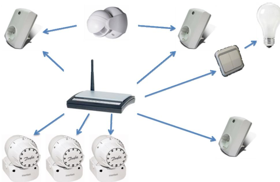
Abbildung 3.18: Beispiel eines Netzes mit statischem Controller
