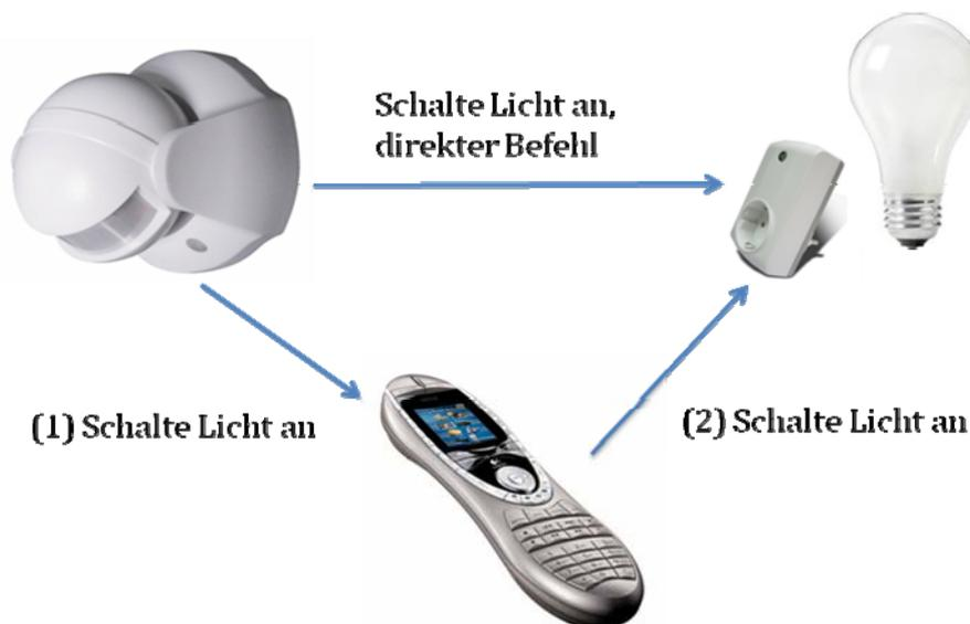
Abbildung 4.11: Kleines Z-Wave-Netz mit Assoziation
