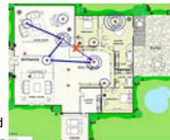
Z-Wave und Zigbee arbeiten mit vermaschten Netzen. Quelle: Z-Wave
