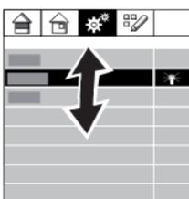
Zur Auswahl eines Menüpunktes und zum Wechsel zwischen den Menüs drücken Sie die rechte Clickwheel-Taste.
