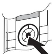
Ett bekräftelsefönster visas. Programmerings-/inlärningsläget är aktiverat i ca 5 sekunder. Under denna tid registreras radiocentralen av det trådlösa USB-gränssnittet och integreras i projektet i radiokonfiguratoren CONNECT.
