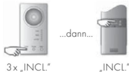
1. Drücken Sie bei der Funk-Zentrale die „INCL.“ Taste 3x innerhalb von 1,5 Sekunden.
