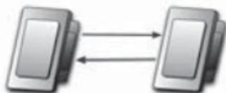
Im Gegensatz zur 1-fach Verknüpfung wird eine weitere Rückverknüpfung programmiert. Es können somit unabhängig von welchen der 4 Aktoren alle 4 Aktoren bedient werden. Ein individuelles Schalten ist im oben gezeigten Beispiel nicht möglich.
