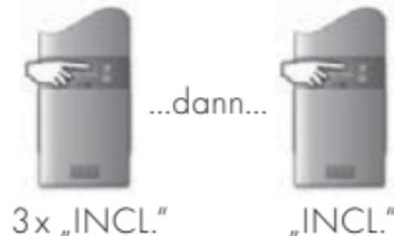
„INCL.“ Taste des Primärcontrollers 3 x innerhalb von 1,5 Sek. drücken (blinkt grün), dann 2 Sekunden „INCL.“ Taste auf der neuen Fernbedienung drücken (blinkt grün). Der Einbinde- und Replikationszyklus beginnt, die Blinkfrequenz erhöht sich auf beiden Fernbedienungen. Ein erfolgreiches Einbinden und Replikation wird durch grünes Leuchten bestätigt.
