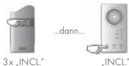
1. Drücken Sie die „INCL.“ Taste Ihres Primärcontrollers 3x innerhalb von 1,5 Sekunden, die LED beginnt grün zu blinken und signalisiert den Wechsel in den Konfigurationsmodus.
