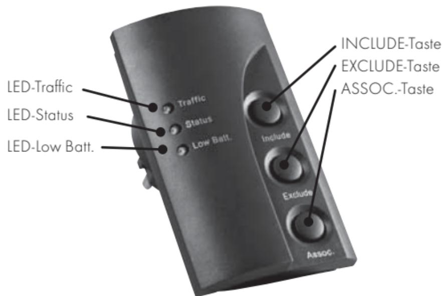
Die **INTERACT<sup>3</sup>** Funk-Zentrale hat die Aufgabe, das Funksystem, beziehungsweise Netzwerk, zu organisieren. Solch eine Funk-Zentrale kommt zum Einsatz, wenn Sie mehr als einen Controller (Funk-Wandsender oder -Fernbedienung) in dem System nutzen. Die Zentrale vereinfacht die Bedienung, koordiniert im Funknetz und überwacht den Batteriezustand Batterie betriebener Teilnehmer und übernimmt eine Vielzahl von Managementfunktionen im Netzwerk.
