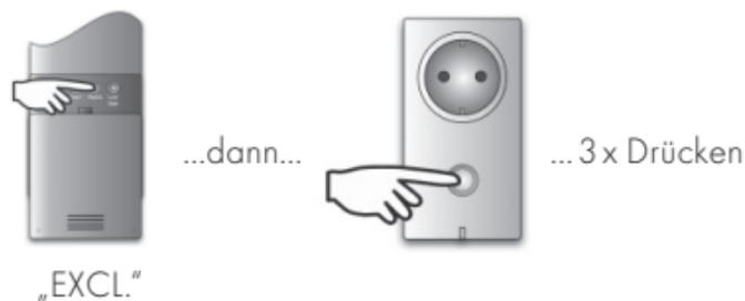
2 Sekunden lang dieTaste „EXCL.“ auf der Funk-Fernbedienung drücken (blinkt grün) und dann 3x innerhalb 1,5 Sekunden auf die Taste „FUNKTION“ drücken.
