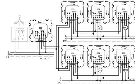
Bij windalarm wordt de jaloezie opgetrokken en blijft vergrendeld tot de wind afneemt. Daarom kunnen de jaloezieën niet handmatig of automatisch worden bediend.
