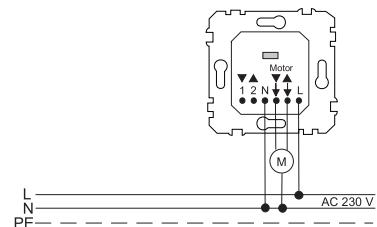
**Attention !** Le potentiel des phases est utilisé pour relier et commander plusieurs mécanismes ! Aussi, pour procéder au câblage, utilisez des câbles NYM classiques.
