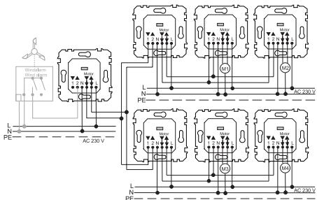
En caso de alarma eólica, la persiana de lamas se sube y permanece bloqueada hasta que cesa el viento. Por eso, las persianas de lamas no se pueden manejar manualmente ni de forma automática.
