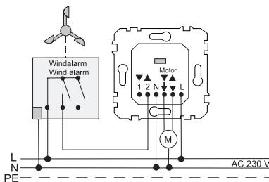
En cas d'alarme de vent, le store est remonté et reste bloqué dans cette position jusqu'à ce que le vent diminue. Il est alors impossible de commander le store manuellement ou automatiquement.
