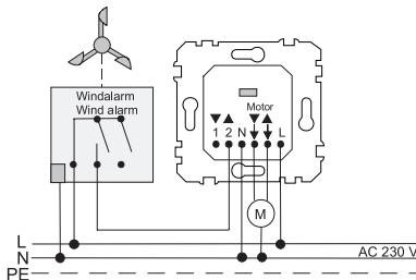
Bei Windalarm wird die Jalousie aufgefahren und bleibt dort verriegelt, bis der Wind abnimmt. Daher kann die Jalousie nicht manuell oder automatisch bedient werden.
