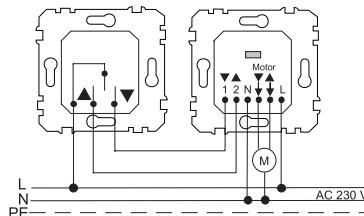
Bi kort pulsen van de rolluik-impulsdrukker gaat de jaloezie-besturingssokkel niet naar automatische vergrendeling (continue bediening). Door de wip-impulsdrukker ingedrukt te houden, kunt U de jaloezie in de gewenste stand brengen. Advies: Voor het schakelen van twee sokkels tussen de sokkels een kabel van 5 x 1,5 mm² gebruiken (1, 2, L, N, PE).
