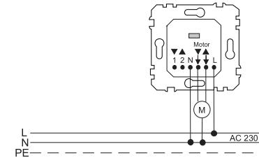
**Atención:** Para interconectar y controlar varios mecanismos se utiliza potencial de fase. Por ello, tienda cables NYM convencionales.
