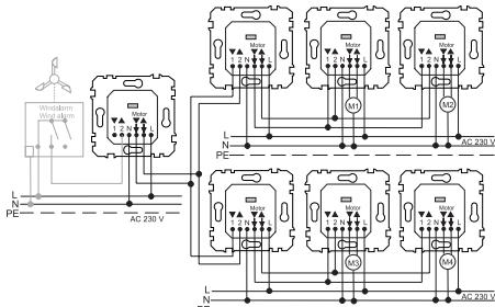
En cas d'alarme de vent, le store est remonté et reste bloqué dans cette position jusqu'à ce que le vent diminue. Il est alors impossible de commander les stores manuellement ou automatiquement.
