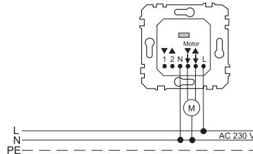
**Let op!** Voor het schakelen en aansturen van meerdere sokkels wordt fasespanning gebruikt! Bedraad daarom met normale NYM-kabels.
