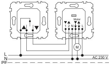
Al presionar ligeramente el pulsador basculante para persianas, el control de persianas de lamas no se para automáticamente (operación continua). Si mantiene presionado el pulsador basculante puede subir o bajar la persiana de lamas hasta la altura deseada. Sugerencia: para interconectar dos mecanismos utilice un cable de 5 x 1,5 mm<sup>2</sup> (1, 2, L, N, PE).
