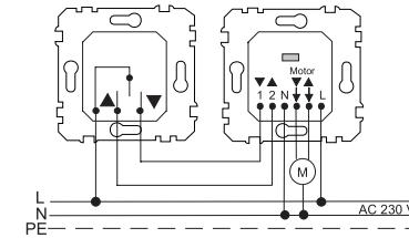
Ao premir por breves instantes a tecla basculante do estore o mecanismo de comando de estores não entra em movimento contínuo (self-hold). Pode colocar o estore na posição pretendida, mantendo a tecla basculante premida. Recomendação: Para interligar dois mecanismos, utilizar o cabo 5 x 1,5 mm<sup>2</sup> (1, 2, L, N, PE).
