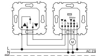
En cas de pression brève sur le bouton-poussoir à bascule pour volets roulants, le mécanisme de commande de stores ne passe pas en mode automaintenu (fonctionnement permanent). Maintenez le bouton-poussoir à bascule enfoncé pour amener le store dans la position souhaitée. Recommandation : Pour relier deux mécanismes, utilisez entre les mécanismes un câble 5 x 1,5 mm<sup>2</sup> (1, 2, L, N, PE).
