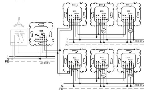
Com o alarme de vento, o estore é levantado e permanece bloqueado nessa posição até o vento diminuir. Por isso, os estores não podem ser operados nem manual nem automaticamente.
