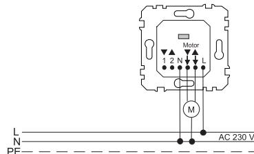
**Achtung!** Zur Verschaltung und Steuerung mehrerer Einsätze wird Phasenpotential verwendet! Verdrahten Sie daher mit handelsüblichen NYM-Leitungen.
