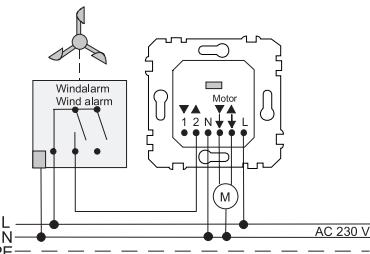
Bij windalarm wordt de jaloezie opgetrokken en blijft vergrendeld tot de wind afneemt. Daarom kan de jaloezie niet handmatig of automatisch worden bediend.
