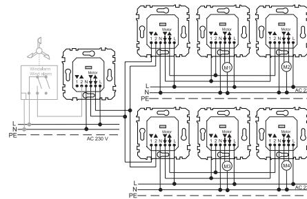
Bei Windalarm wird die Jalousie aufgefahren und bleibt dort verriegelt, bis der Wind abnimmt. Daher können die Jalousien nicht manuell oder automatisch bedient werden.
