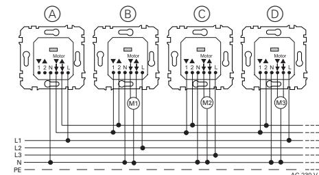
Mécanismes de commandes centralisées, répartis sur plusieurs phases. Les mécanismes peuvent être branchés au choix sur différentes phases.
