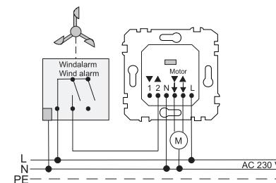
Com o alarme de vento, o estore é levantado e permanece bloqueado nessa posição até o vento diminuir. Por isso, o estore não pode ser operado nem manual nem automaticamente.
