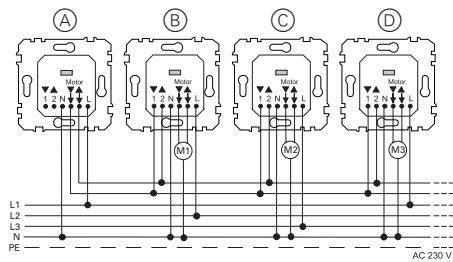
Mecanismos con control centralizado distribuidos en varias fases. Los mecanismos se pueden conectar al borne de cualquiera de las distintas fases.
