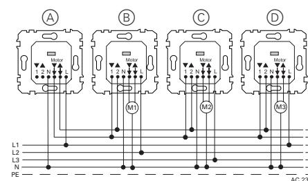
Einsätze in Zentralsteuerung, auf mehrere Phasen verteilt. Die Einsätze können beliebig auf verschiedene Phasen geklemmt werden.
