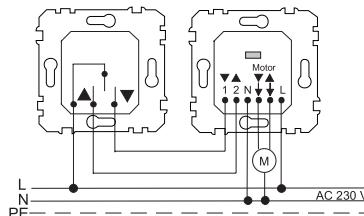
Bei kurzzeitigem Tasten des Rolladen-Wipp-Tasters geht der Jalousiesteuerungs-Einsatz nicht in Selbstthal- tung (Dauerlauf). Sie können die Jalousie durch gedrückt halten der Wipptaste in die gewünschte Position fahren. Empfehlung: Zur Verschaltung zweier Einsätze zwischen den Einsätzen Leitung 5 x 1,5 mm<sup>2</sup> verwenden (1, 2, L, N, PE).
