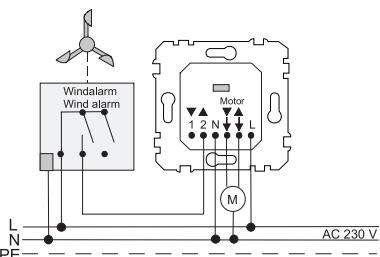
En caso de alarma eólica, la persiana de lamas se sube y permanece bloqueada hasta que cesa el viento. Por eso, la persiana de lamas no se puede manejar manualmente ni de forma automática.
